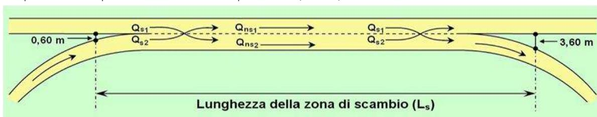
Figura 21 – Schematizzazione zona di scambio
