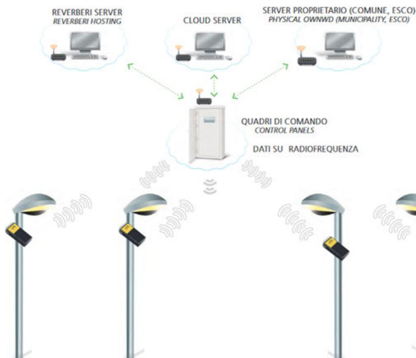
Figura 67 - Architettura del sistema di telegestione e telecontrollo
