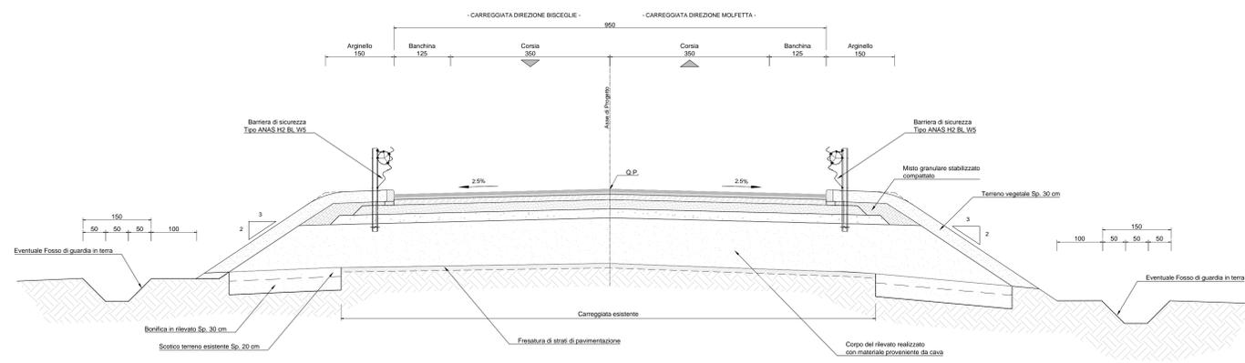
SEZIONE TIPO DI PROGETTO ASSE A CON OPERE DI SOSTEGNO
