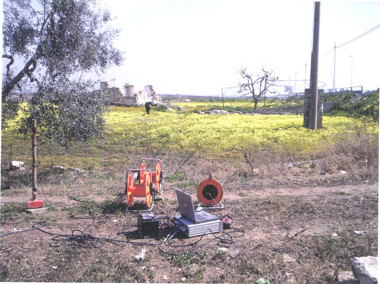
Rilievo Sismico SS3
