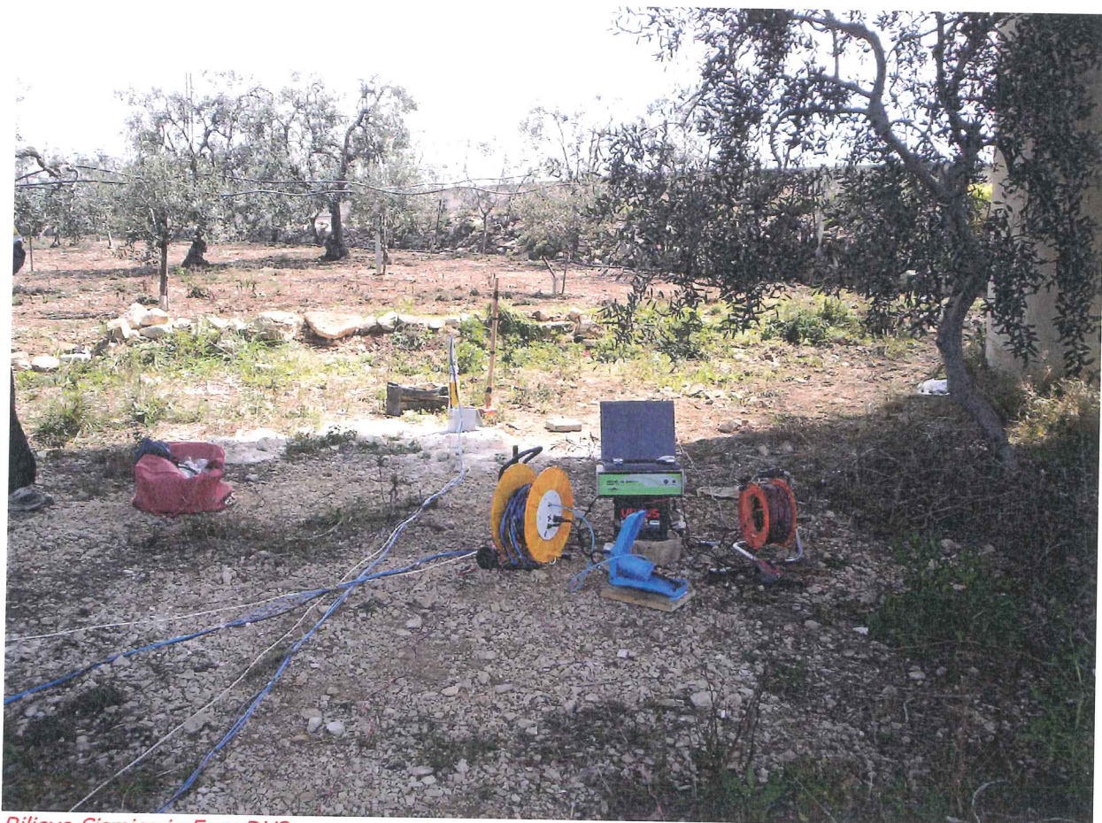
Rilievo Sismico in Foro DH3
