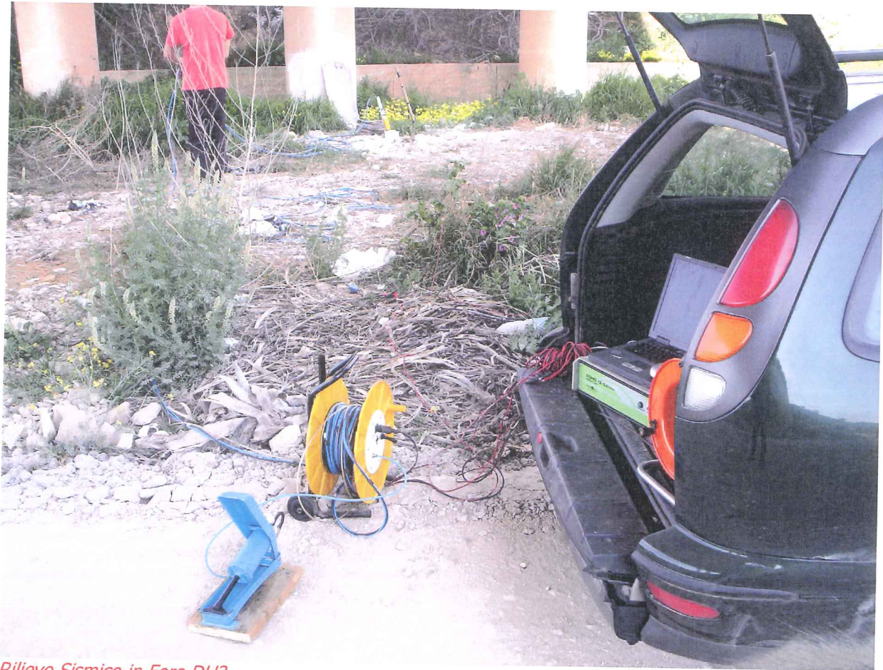
Rilievo Sismico in Foro DH2
