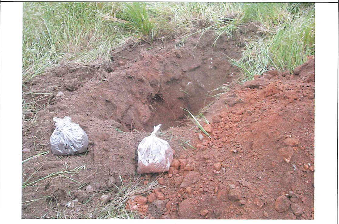
Esecuzione pozzetto geognostico e prelievo dei campioni Ca1 alle diverse profondità
