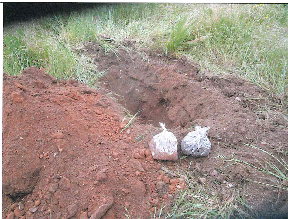
Esecuzione pozzetto geognostico e prelievo dei campioni Ca4 alle diverse profondità
