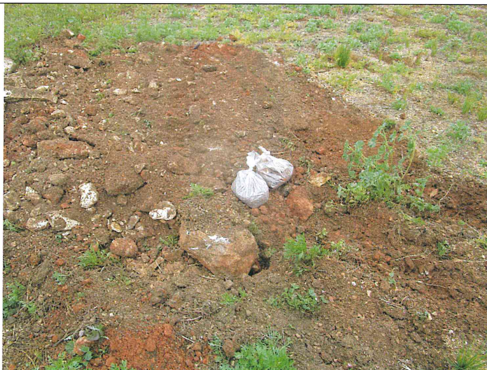
Esecuzione pozzetto geognostico e prelievo dei campioni Ca5 alle diverse profondità
