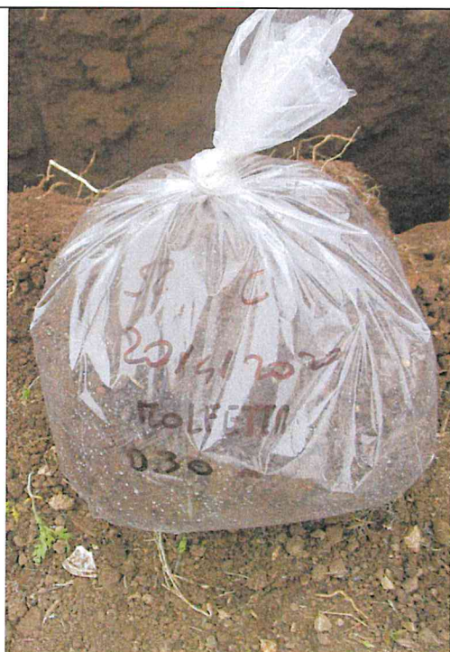
Esecuzione pozzetto geognostico e prelievo dei campioni Ca2 alle diverse profondità
