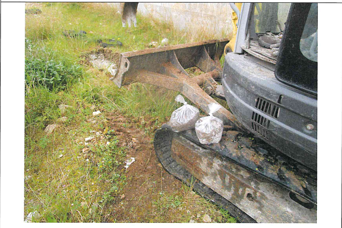
Esecuzione pozzetto geognostico e prelievo dei campioni Ca7 alle diverse profondità
