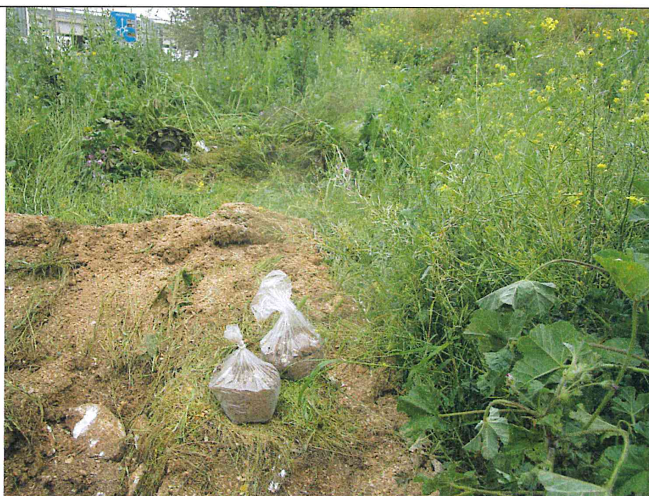
Esecuzione pozzetto geognostico e prelievo dei campioni Ca6 alle diverse profondità
