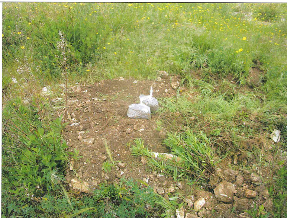
Esecuzione pozzetto geognostico e prelievo dei campioni Ca9 alle diverse profondità
