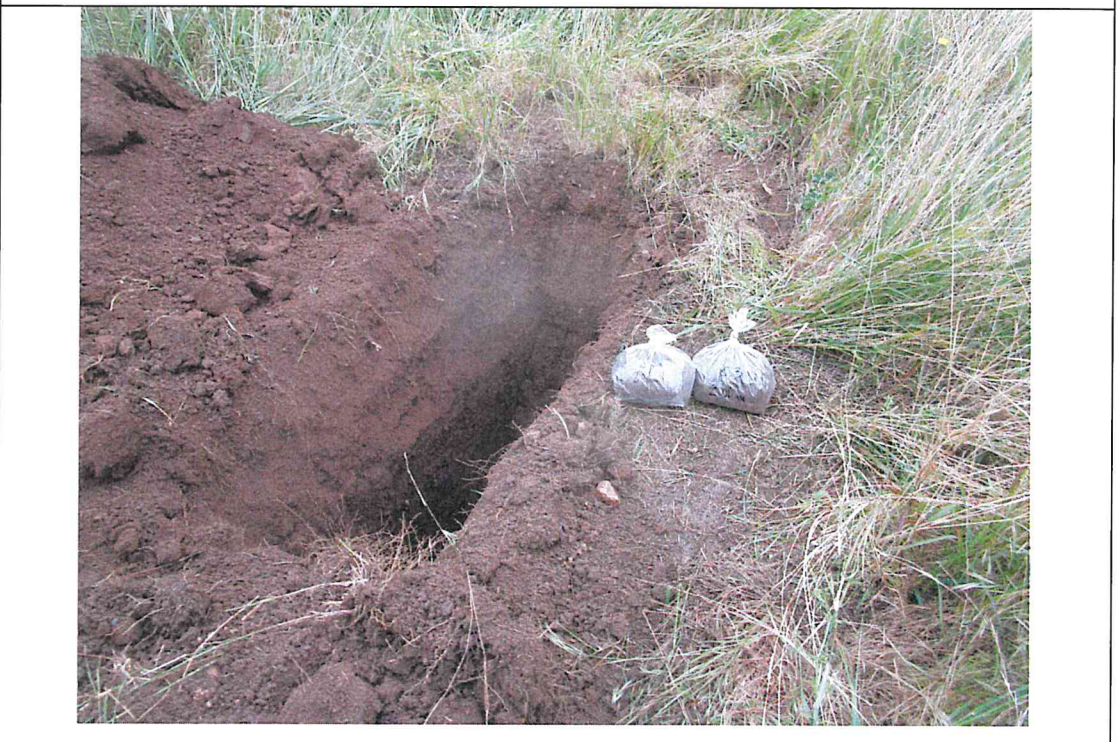
Esecuzione pozzetto geognostico e prelievo dei campioni Ca3 alle diverse profondità
