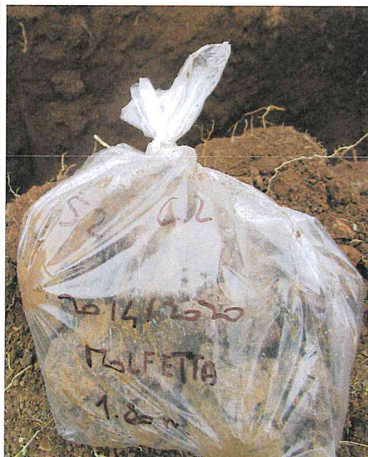
Esecuzione pozzetto geognostico e prelievo dei campioni Ca2 alle diverse profondità
