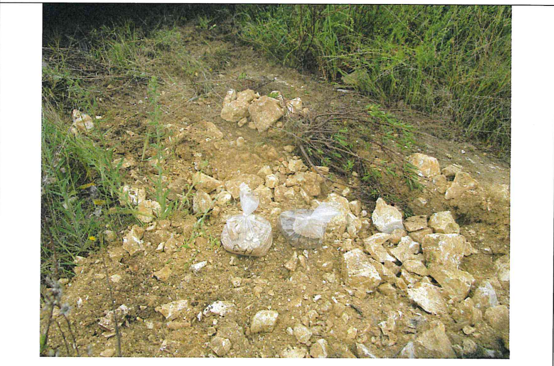
Esecuzione pozzetto geognostico e prelievo dei campioni Ca11 alle diverse profondità
