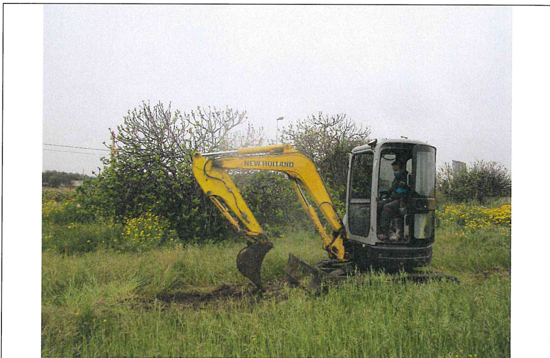
Esecuzione pozzetto geognostico e prelievo dei campioni Ca4 alle diverse profondità
