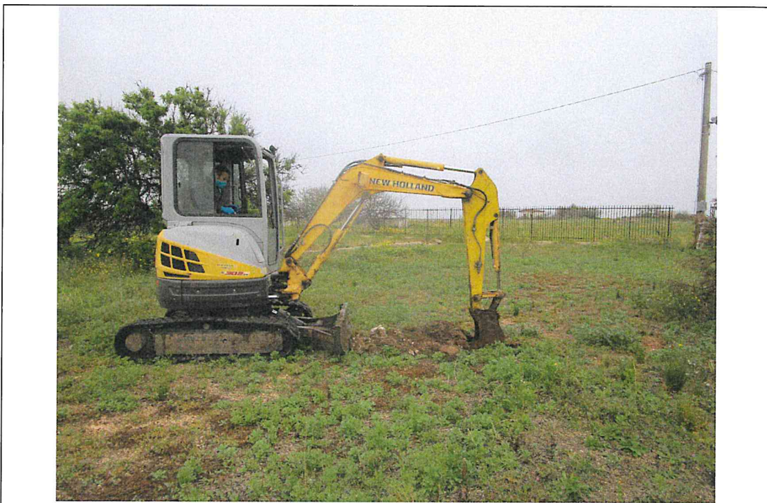
Esecuzione pozzetto geognostico e prelievo dei campioni Ca5 alle diverse profondità
