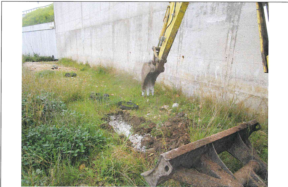
Esecuzione pozzetto geognostico e prelievo dei campioni Ca7 alle diverse profondità
