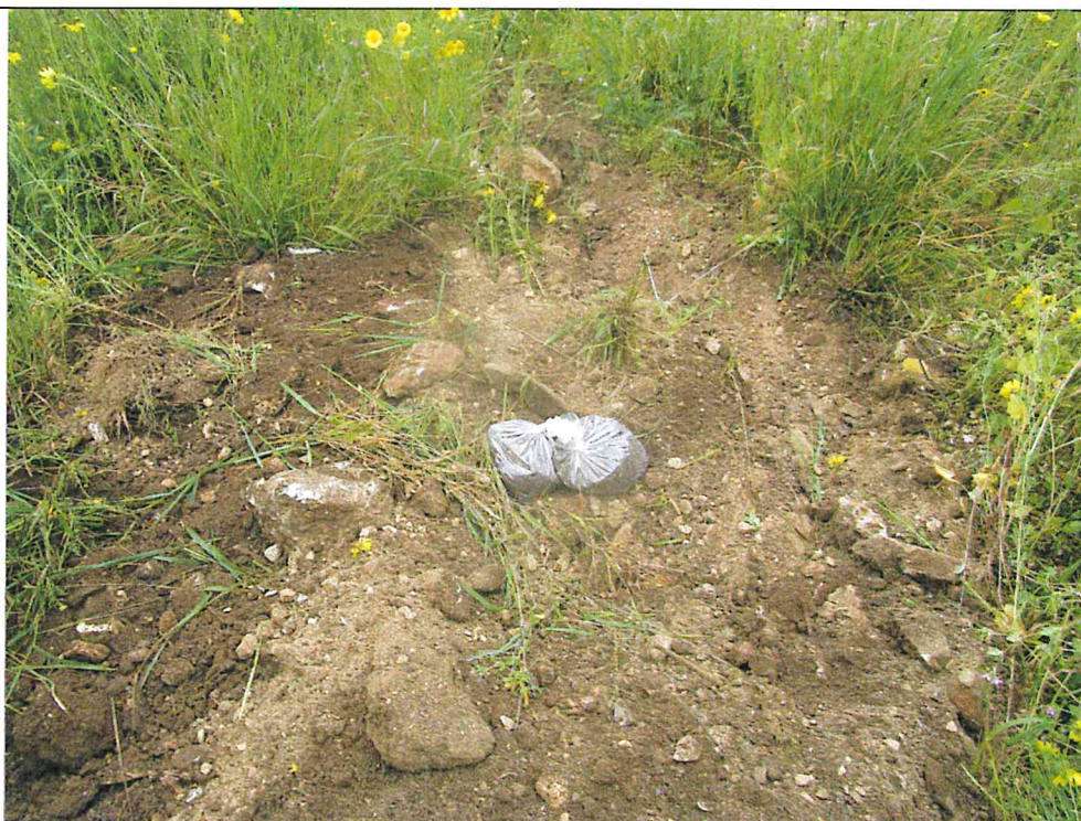
Esecuzione pozzetto geognostico e prelievo dei campioni Ca8 alle diverse profondità
