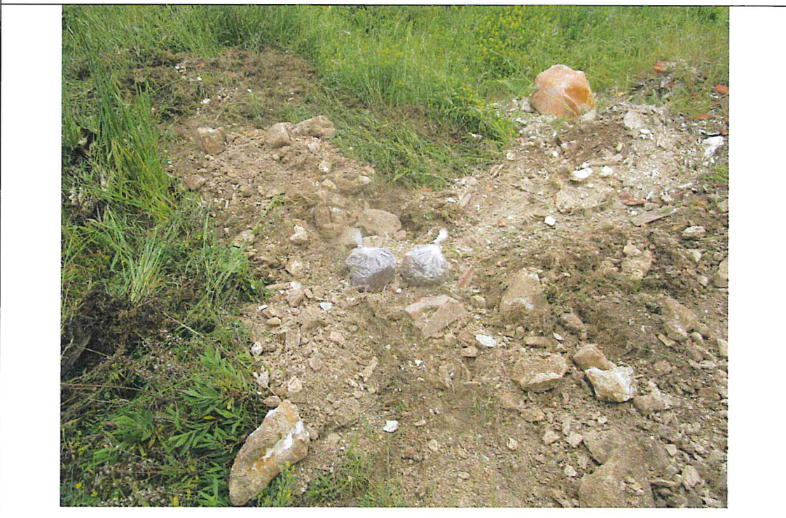
Esecuzione pozzetto geognostico e prelievo dei campioni Ca10 alle diverse profondità
