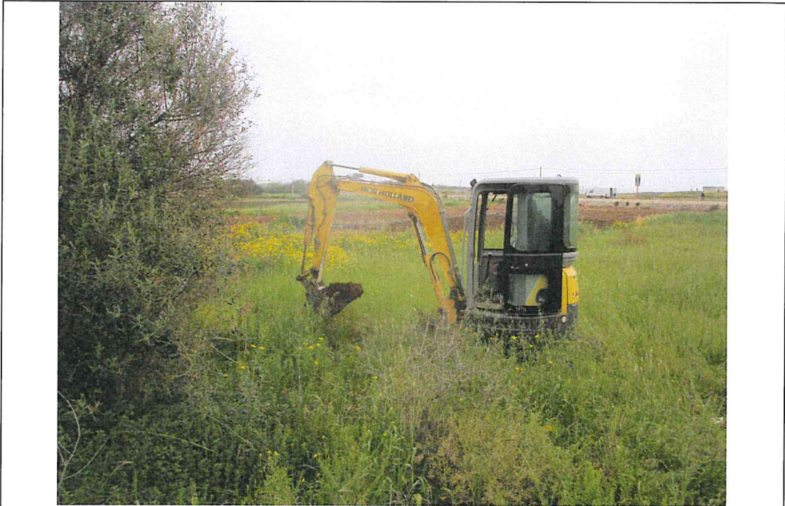
Esecuzione pozzetto geognostico e prelievo dei campioni Ca1 alle diverse profondità
