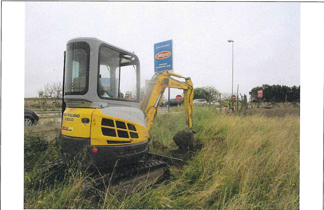
Esecuzione pozzetto geognostico e prelievo dei campioni Ca3 alle diverse profondità
