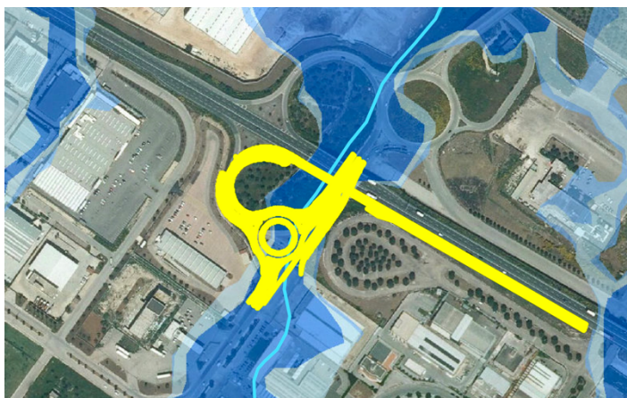
Figura 3.2 – Sovrapposizione della cartografia di piano AdB con l'intervento "Bretella di collegamento - SS16"
