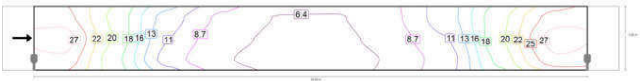
Valore di manutenzione illuminamento orizzontale [lx] (Curve isolux)
