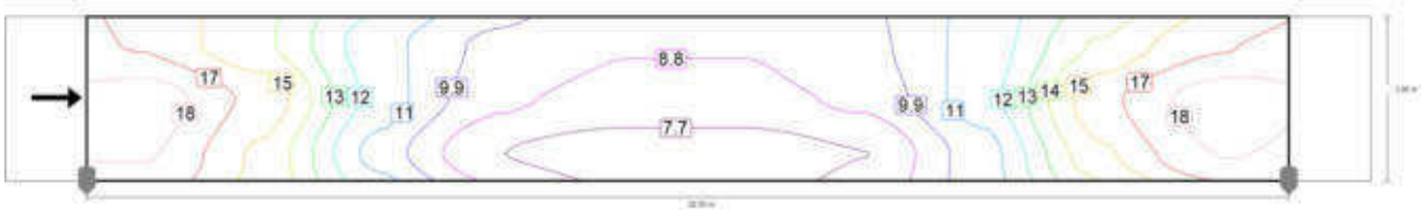
Valore di manutenzione illuminamento orizzontale [lx] (Curve isolux)
