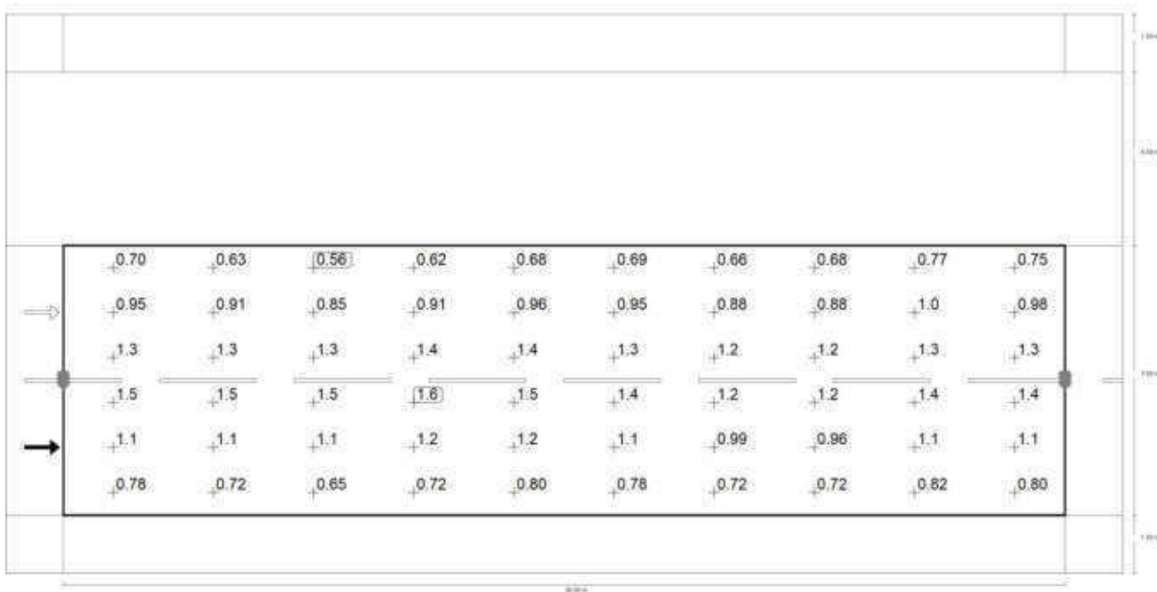
Osservatore 1: Valore di manutenzione luminanza con carreggiata asciutta [cd/m 2 ] (Raster dei valori)
