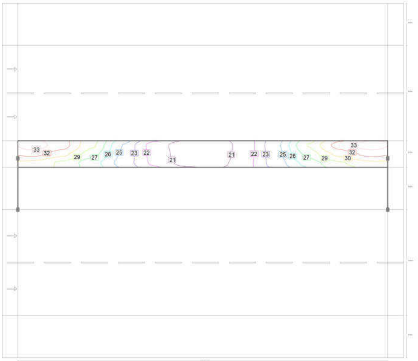
Valore di manutenzione illuminamento orizzontale [lx] (Curve isolux)
