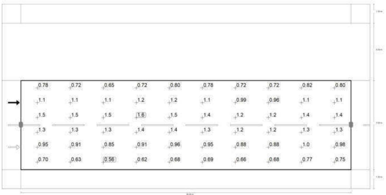
Osservatore 2: Valore di manutenzione luminanza con carreggiata asciutta [cd/m 2 ] (Raster dei valori)
