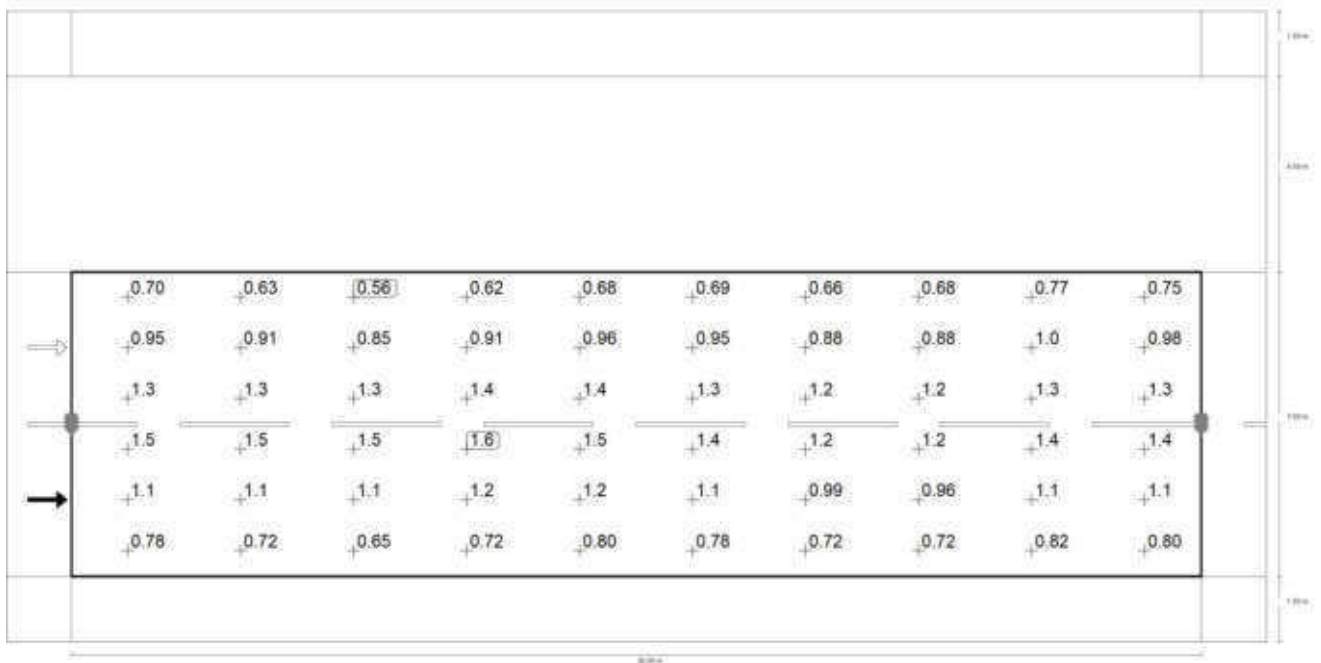
Osservatore 1: Valore di manutenzione luminanza con carreggiata asciutta [cd/m 2 ] (Raster dei valori)
