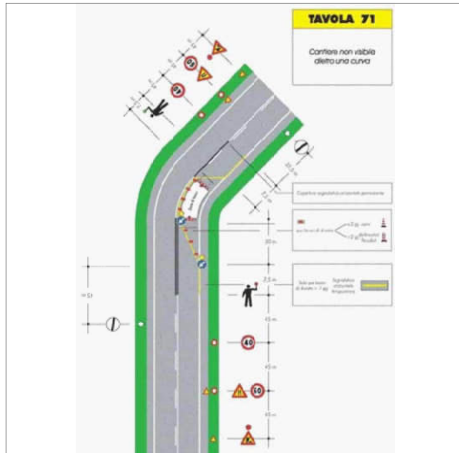
CANTIERE NON VISIBILE DIETRO CURVA
