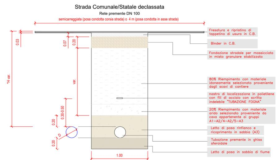
\* per H < 0.90 prevedere una protezione della condotta con soletta in cls CL25 e rete elettrosaldata Ø 12 maglia 15x15
