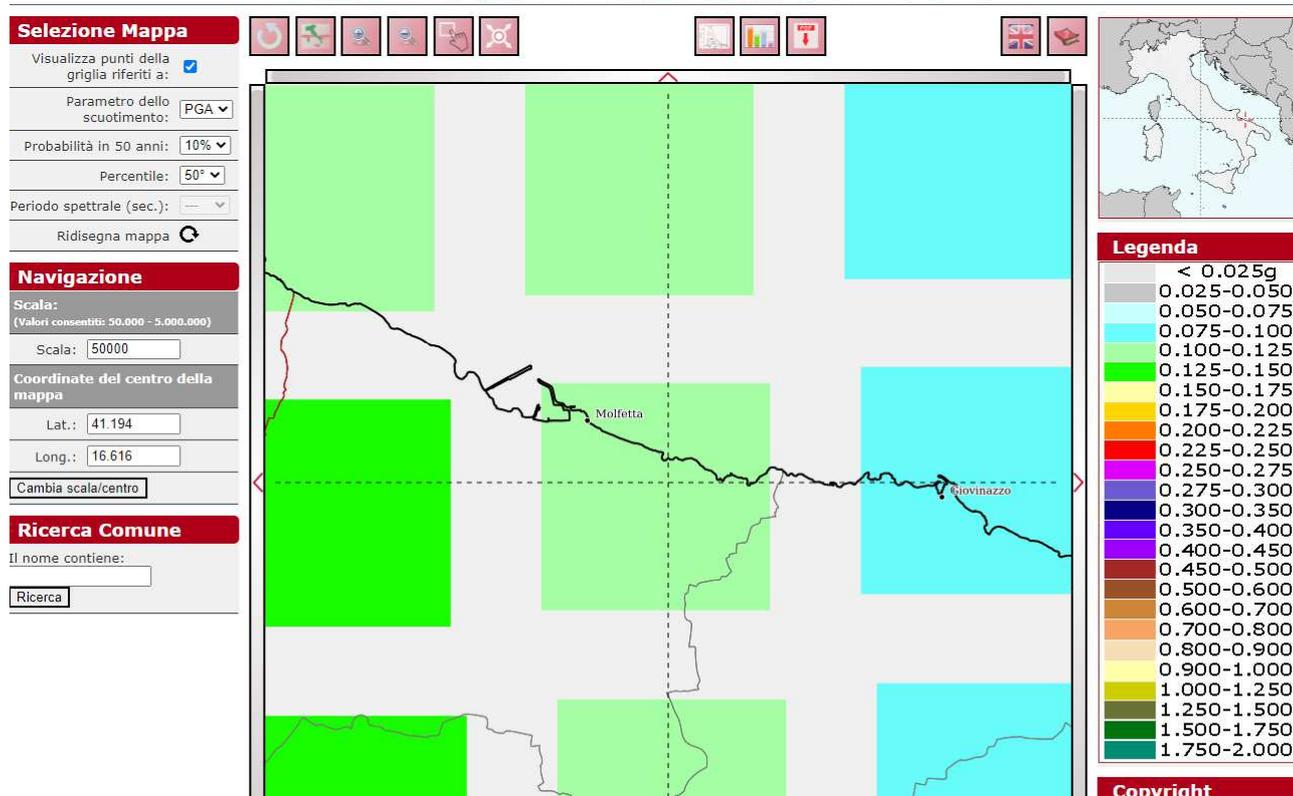
**TAV. 17: Zonazione sismica nazionale (web-gis) in termini di accelerazione sismica locale**
