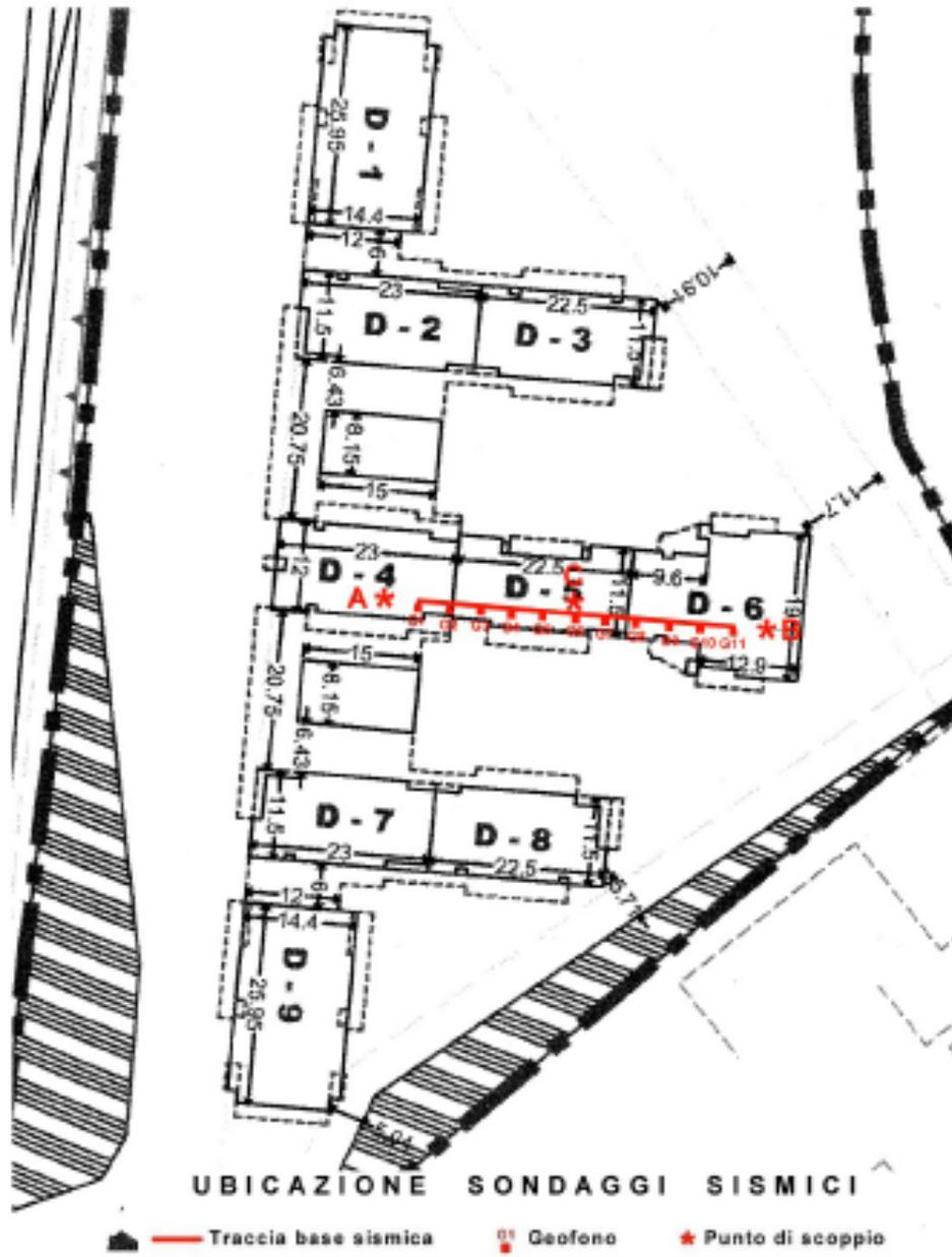
Come energizzazione è stata utilizzata una mazza battente (da 8 Kg) sia per generare le onde di tipo P (longitudinali) che per generare le onde di tipo S (Trasversali).
