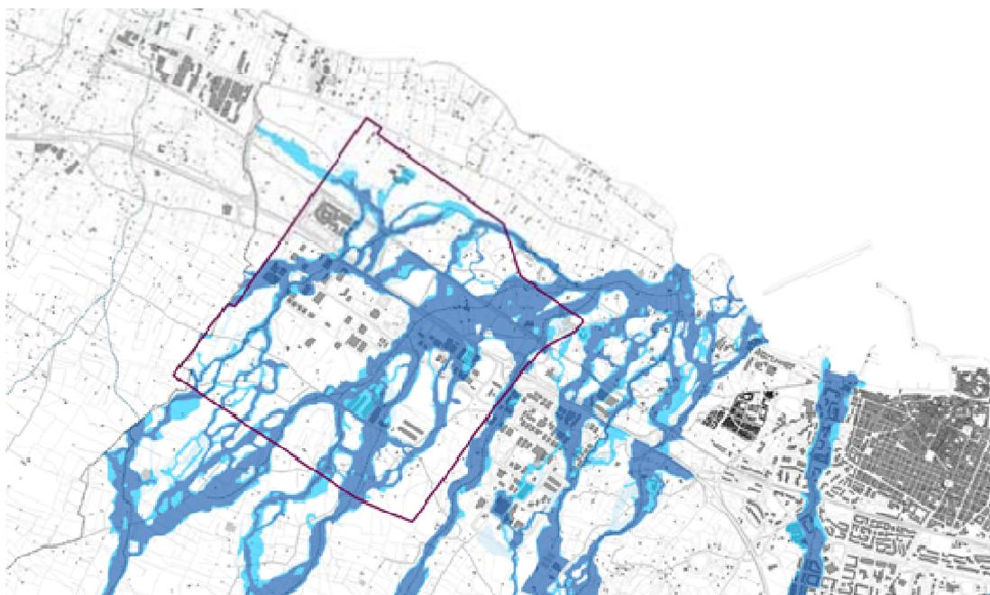
Per entrambi gli interventi quindi sono stati effettuati studi idraulici con modellazione pre e post operam le cui relazioni tecniche sono allegati alla progettazione; per quanto riguarda l'intervento in zona ASI, a seguito della realizzazione dell'opera di salvaguardia, l'agglomerato industriale risulta non interessato dalle aree a diversa pericolosità idraulica se non per una zona molto contenuta la cui pericolosità è dovuta al regime idraulico della lama Marcinase.
