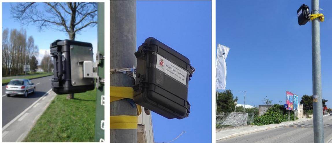
Figure 35, 36 e 37: Dispositivo radar di rilievo del traffico
