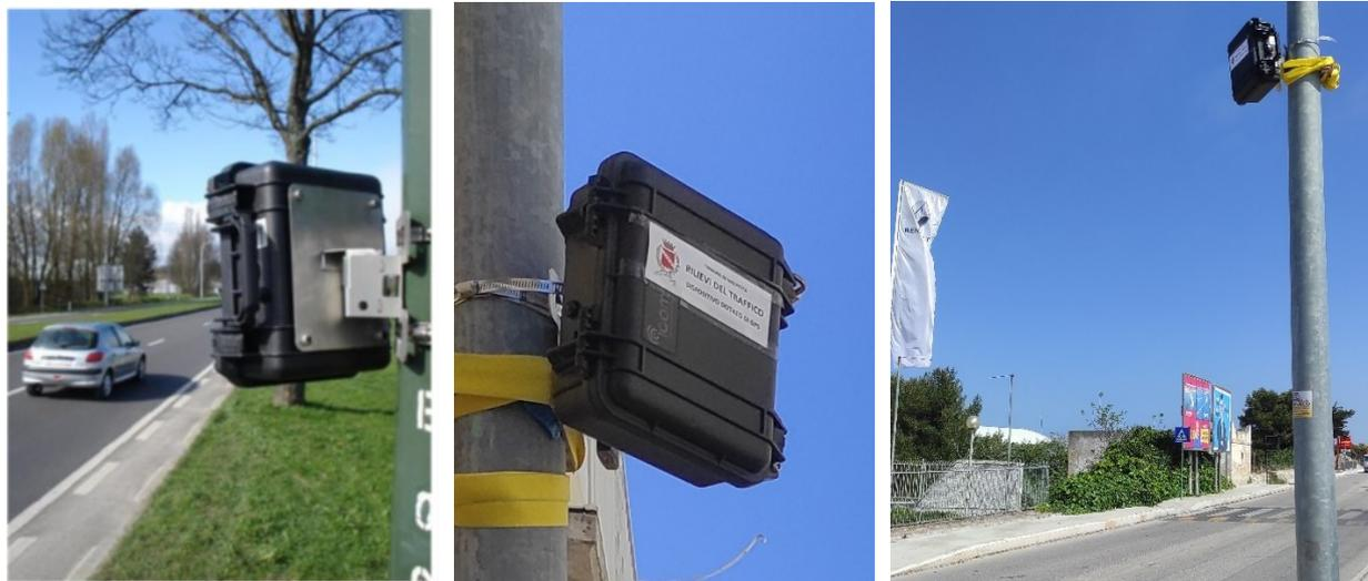
Dispositivo radar di rilievo del traffico
